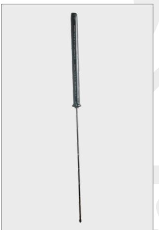
La massa battente MBGRG080 è una sonda a percussione manuale progettata per effettuare fori fino ad una profondità di 700 mm e di diametro 12 mm. La particolare forma ad oliva permette di penetrare il terreno morbido, di non impuntarsi sui tubi o pietre che si oppongono deviando la direzione, sotto il manto stradale preventivamente forato.
